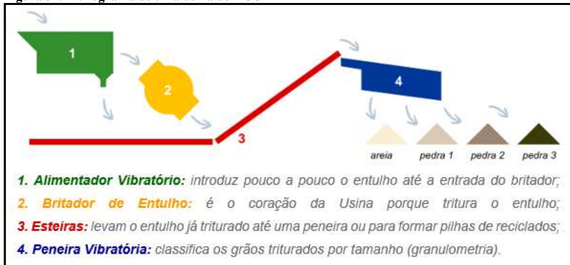
Figura 32. Fluxograma de uma usina de RCC
