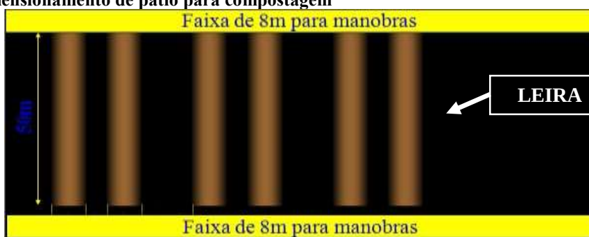
Figura 28. Dimensionamento de pátio para compostagem 7
