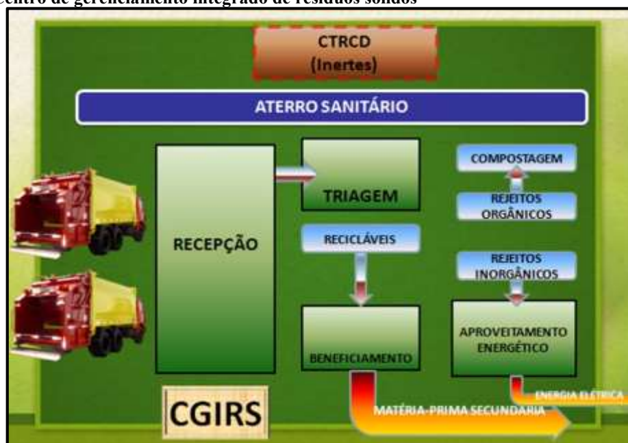
Figura 45. Centro de gerenciamento integrado de resíduos sólidos
