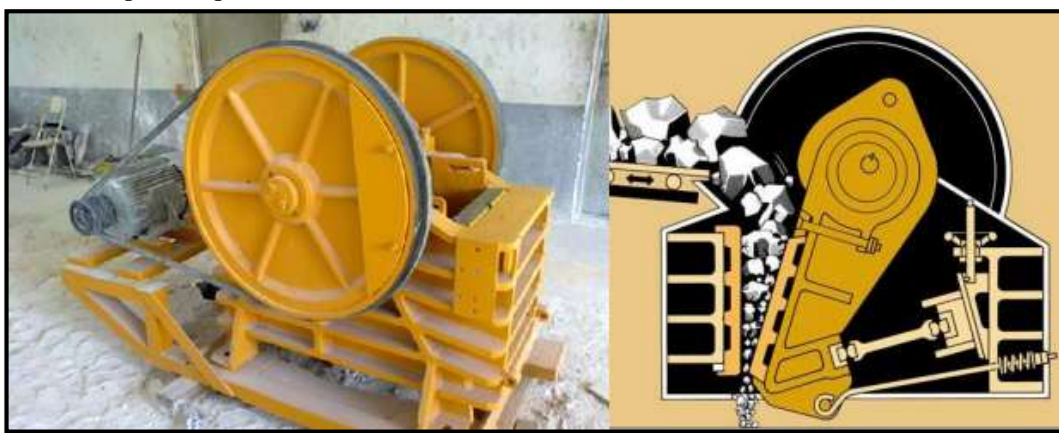
Figura 34. Exemplo e esquema de britador mandíbula
